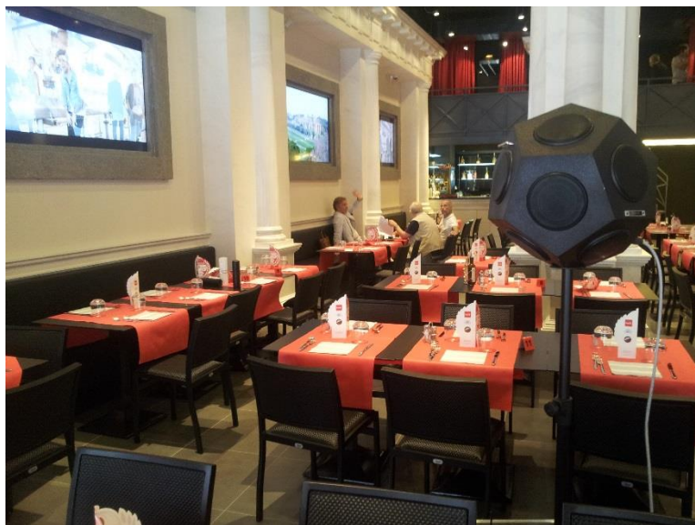
Figura N°2 Immagine riferita alla sorgente omnidirezionale
